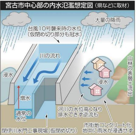
宮古市中心部の浸水被害と閉伊川水門事業市による閉伊川沿岸の新川町、大通、築地、愛宕、光岸地、藤原を中心に浸水被害を受け面積は調査中。宮古地区全体の家屋被害は15日現在、1761棟を数える。閉伊川水門(延長1544.4m、高さ10.4m)は津波対策として整備され、2020年度のゲート全開時は100年に1度の洪水に対応する1秒当たり4200立方メートルの流量を確保する。総事業費は295億円。
